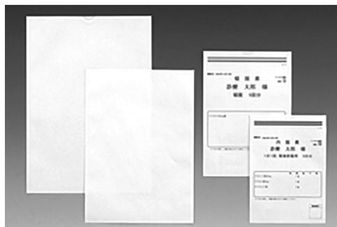
厚紙印刷で発生しやすい、トナー定着性能の品質確認のため各プリンターごとに印刷可能な最大紙厚用紙で印刷テストを実施しています。
